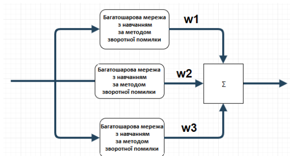
Рис. 2. Структура нейронної мережі з конфігурацію прямого поширення з навчанням за методом зворотного поширення похибки
