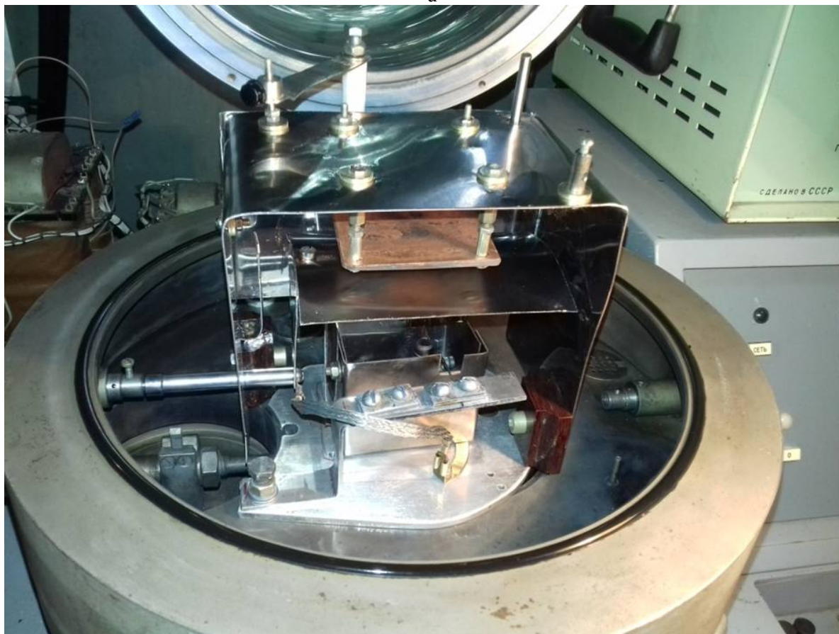
Рис. 1. Приспособление для термического напыления металла в вакууме
