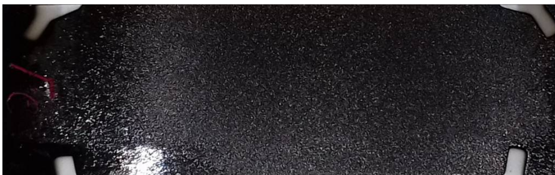
Рис. 2. Пленка железа, нанесенная на стеклянную подложку при минимальной скорости испарения
