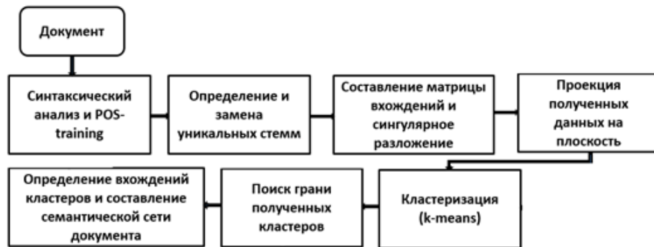
Рис. 1. Общая структура автоматического построения программной семантической сети документа.
