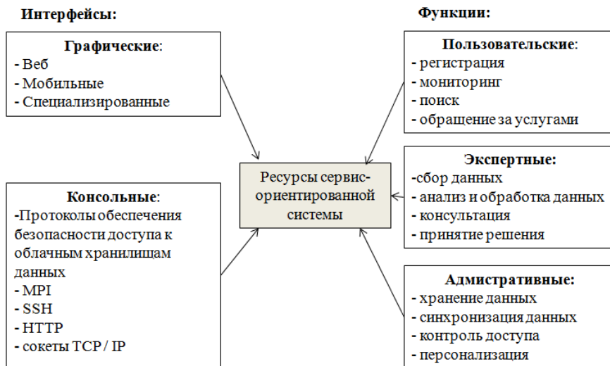
Рис.2. Структура интерфейсов многоагентной системы распределенной нейросетевой обработки больших данных
