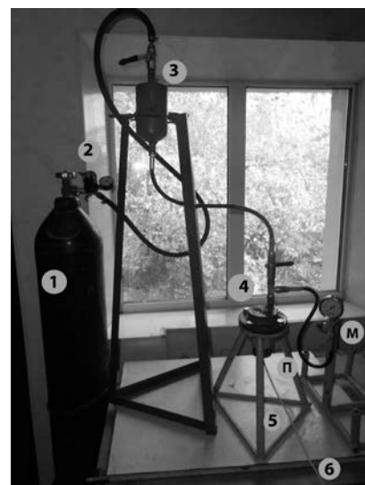
Рис. 1. Блок-схема експериментальної установки для дослідження фільтрації рідини пористими середовищами: 1-балон з газом (азот) високого тиску, 2-редуктор для регулювання величини тиску, 3-ресивер з рідиною, 4-кертримач, 5-мірний стакан, або точні терези, 6-генератор акустичних коливань видає сигнал на п'єзовипромінювач П всередині кертримача, Х-крани, М-манометри
