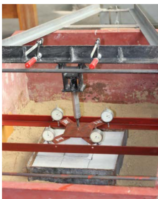
Рис. 4. Опытно-производственный стенд для исследования покрытий из ФЭМ с измененной геометрической формой основания
