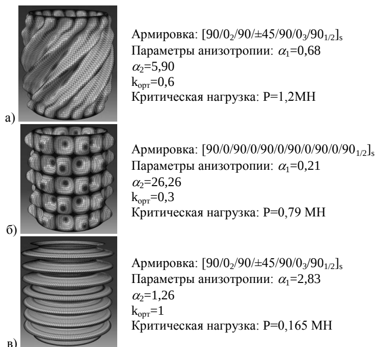
Рис. 3. Формы потери устойчивости многослойных анизотропных оболочек
