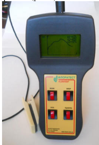
Рис. 6. "Флоратест" - прилад для функціональної діагностики стану рослин в польових умовах.
