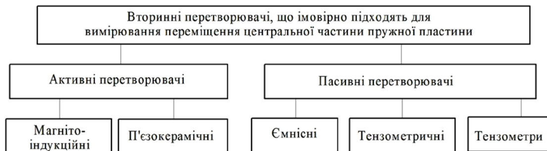
Рис. 2. Класифікація вторинних перетворювачів, які імовірно підходять для вимірювання переміщення центральної частини пружної пластини.
